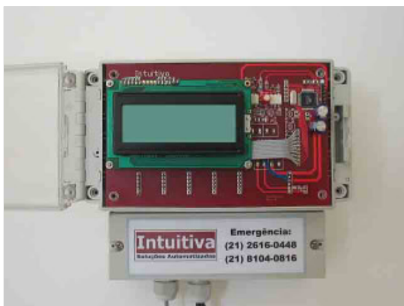
Caixa com controlador
